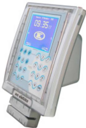
I terminali della serie "FLAT" rappresentano il massimo della tecnologia applicata ai lettori di badge per gli usi più variegati (rilevamento presenze, controllo accessi, raccolta dati di produzione, raccolta dati mensa, ecc.).
